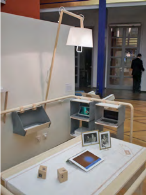
Abbildung 3.27: Testaufbau Haussteuerung und grafische Benutzeroberfläche (hier: Licht einschalten/dimmen)
