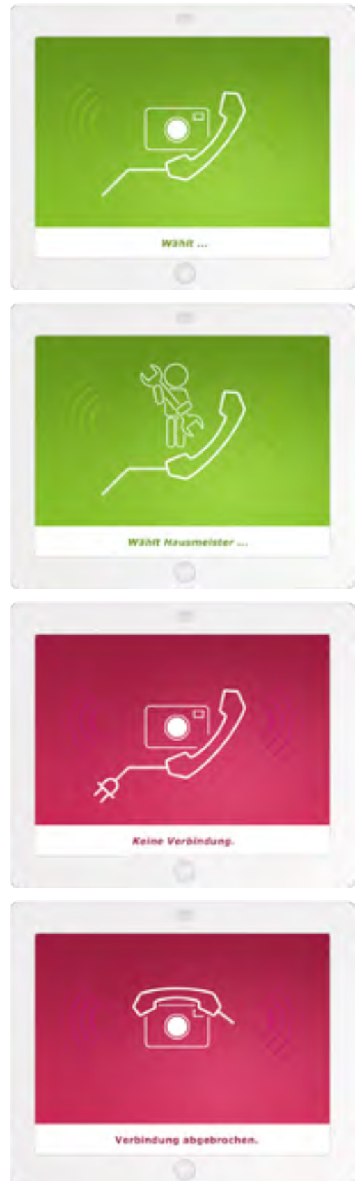
Abbildung 3.14: grafische Benutzeroberfläche Bilderrahmen (Oben: Verbindungsaufbau allgemein und speziell mit dem Hausmeister; Unten: Teilnehmer ist nicht erreichbar und Verbindungsabbruch)
