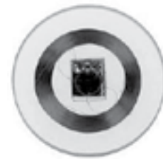
Abbildung 3.13: RFID-Transponder (Durchmesser: ca. 15 mm)
