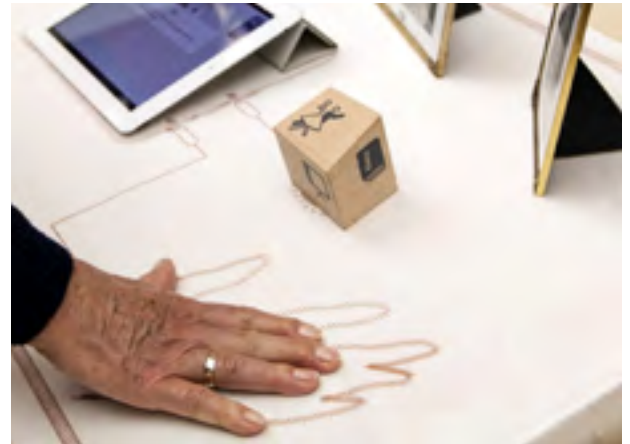
Abbildung 3.26: Testaufbau Messung von Vitaldaten durch Handauflegen
