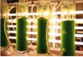
Forscher der HS Anhalt entwickeln Verfahren zur Bio-Energie-Gewinnung aus Algen (Mikroalgen im Bläsensäulenreaktor)
