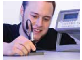
Hochauflösende Ultraschallprüftechnik, HS Merseburg
