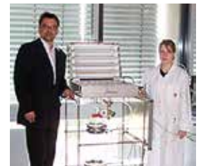
Solar-Photokatalysator auf Basis mineralischer Träger zum Abbau von Pharmakarreststoffen in Wasser, HS Anhalt
